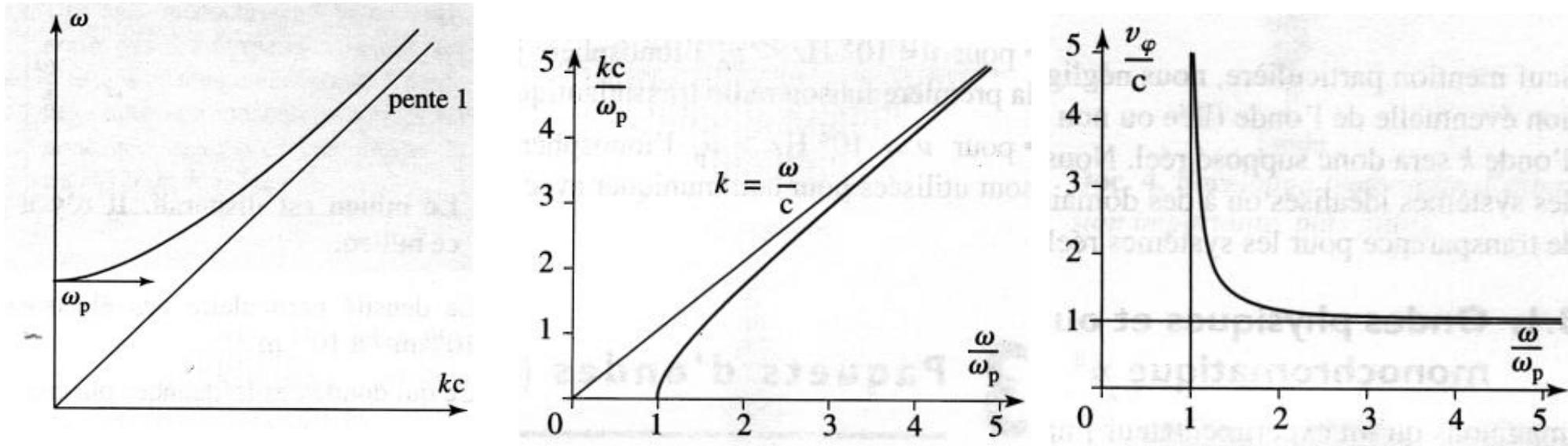
*A haute fréquence,  $k \approx \frac{\omega}{c}$  et  $v_\phi \approx c$  : le comportement du plasma est proche de celui du vide (à cause de l'inertie des électrons).*
