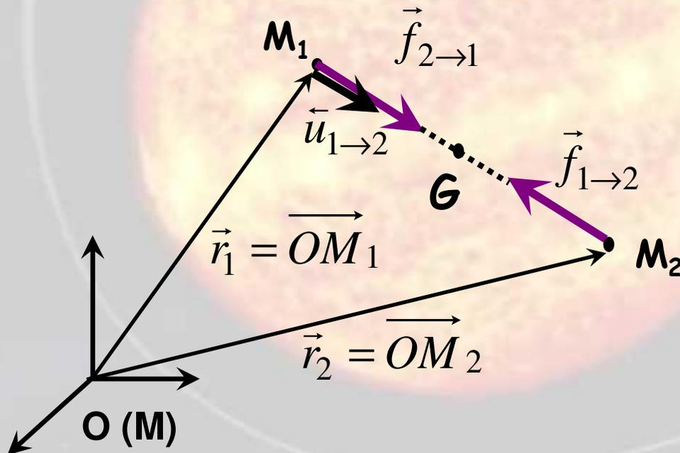
Le PFD appliqué au point  $M_1$  dans le référentiel barycentrique fait apparaître, en plus des forces réelles, la force d'inertie d'entraînement
