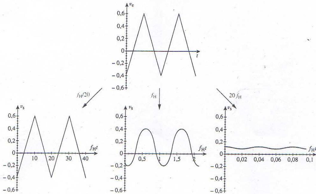
Filtre passe-bas du premier ordre. Réponse d'un signal triangulaire d'amplitude crête-crête 1 V, de fréquence  $f_H/20$ ,  $f_H$  et  $20 f_H$ , superposé à une composante continue de 0,1 V.
