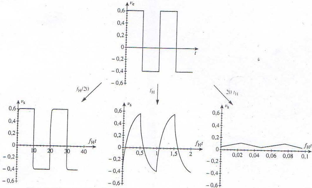
Filtre passe-bas du premier ordre. Réponse à un signal en créneaux d'amplitude crête-crête 1 V, de fréquence  $f_H/20$ ,  $f_H$  et  $20 f_H$ , superposé à une composante continue de 0,1 V.
