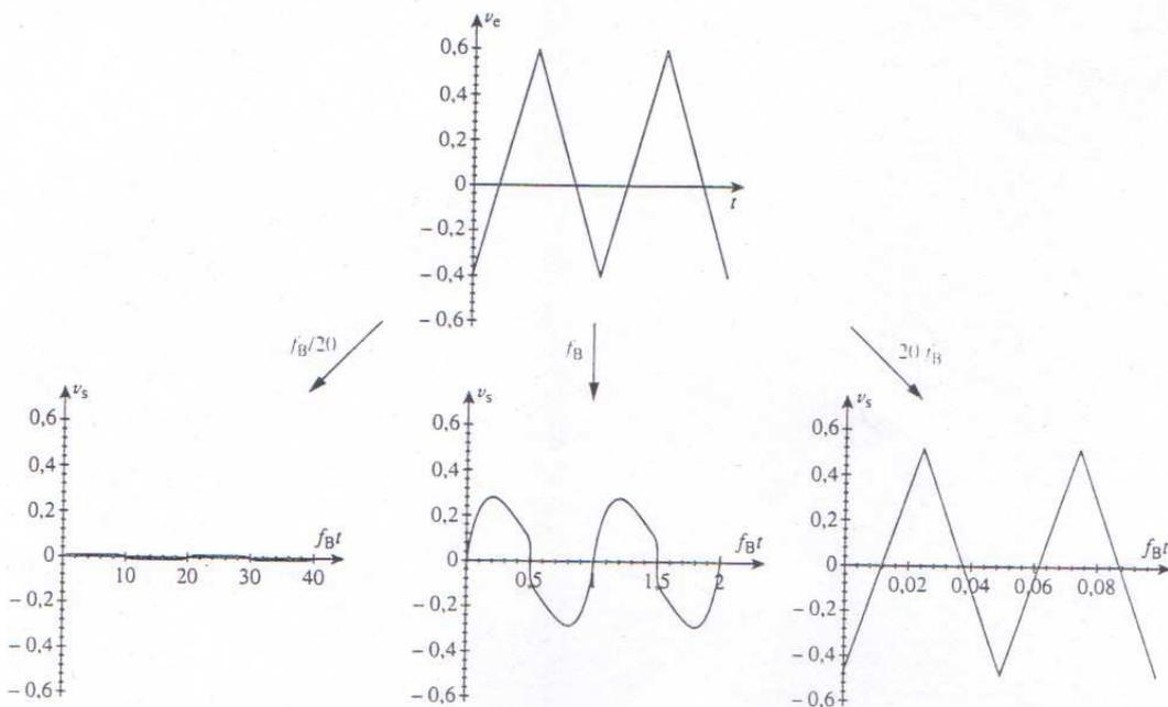
Filtre passe-haut du deuxième ordre ( $Q = 0,7$ ). Réponse à un signal triangulaire d'amplitude crête-crête 1 V, de fréquence  $f_B/20$ ,  $f_B$  et  $20 f_B$ , superposé à une composante continue de 0,1 V.
