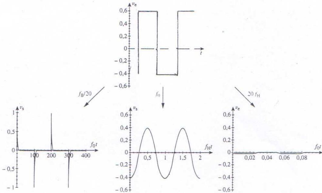
Filtre passe-bande de coefficient de qualité  $Q = 0,1$ ,  $f_B = 0,1 f_0$  et  $f_H = 10 f_0$ . Réponse à un signal en créneaux d'amplitude crête-crête 1 V de fréquence  $f_B/20$ ,  $f_0$ ,  $20 f_H$  superposé à une composante continue de 0,1 V.
