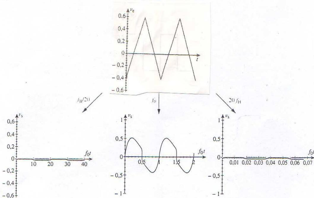
Filtre passe-bande de coefficient de qualité  $Q = 10$ ,  $f_B \approx 0,95 f_0$  et  $f_H \approx 1,05 f_0$ . Réponse à un signal triangulaire d'amplitude crête-crête 1 V, de fréquence  $f_B/20, f_0, 20 f_H$  superposé à une composante continue de 0,1 V.
