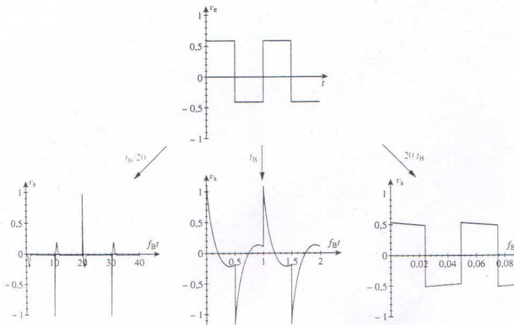
Filtre passe-haut du deuxième ordre ( $Q = 0,7$ ). Réponse à un signal créneau d'amplitude 1 V, de fréquence  $f_B/20$ ,  $f_B$  et  $20 f_B$ , superposé à une composante continue de 0,1 V.
