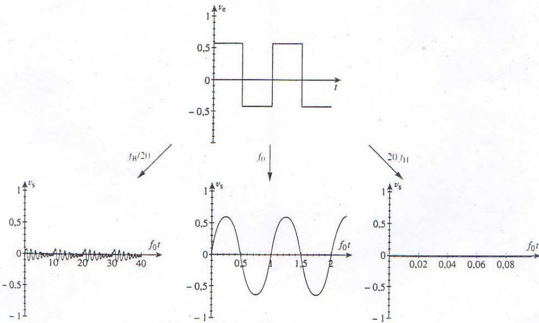
Filtre passe-bande de coefficient de qualité  $Q = 10$ ,  $f_B \approx 0,95 f_0$  et  $f_H \approx 1,05 f_0$ . Réponse à un signal en créneaux d'amplitude crête-crête 1 V, de fréquence  $f_B/20, f_0, 20 f_H$  superposé à une composante continue de 0,1 V.
