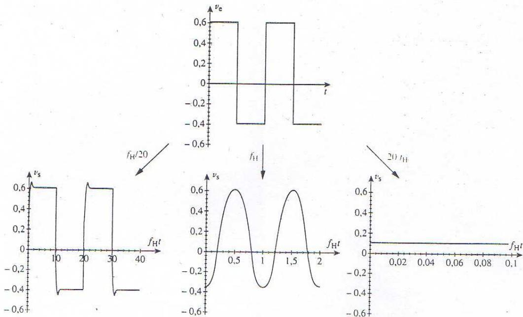
Filtre passe-bas du second ordre. Réponse à un signal en créneaux d'amplitude crête-crête 1 V, de fréquence  $f_H/20$ ,  $f_H$  et  $20 f_H$ , superposé à une composante continue de 0,1 V.
