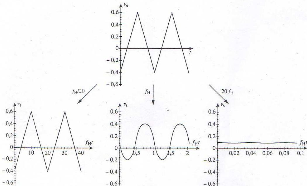
Filtre passe-bas du deuxième ordre. Réponse d'un signal triangulaire d'amplitude crête-crête 1 V, de fréquence  $f_H/20$ ,  $f_H$  et  $20 f_H$ , superposé à une composante continue de 0,1 V.
