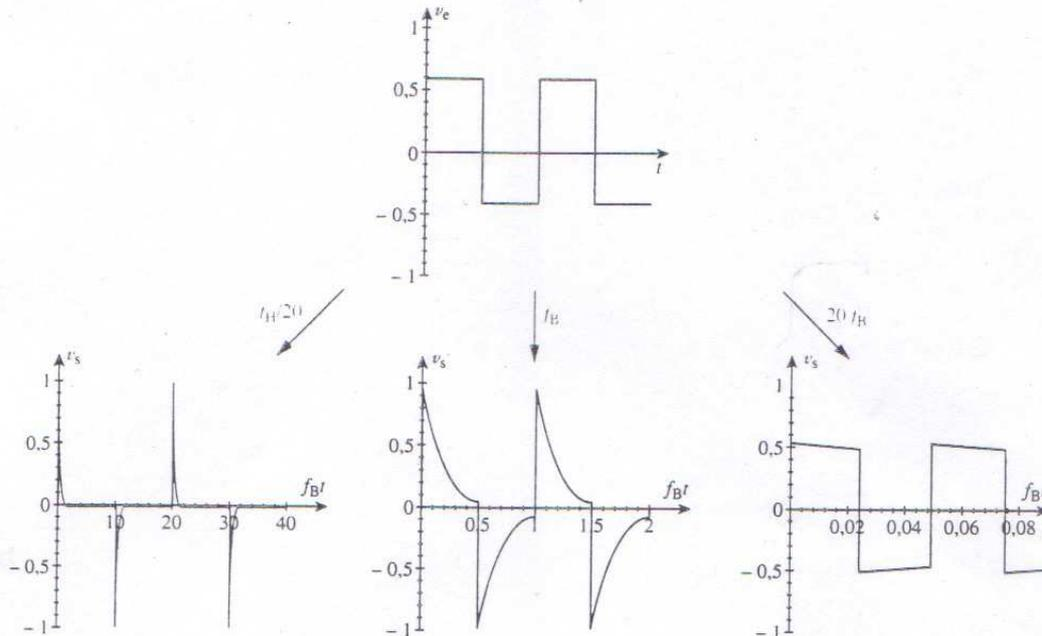
Filtre passe-haut du premier ordre. Réponse à un signal créneau d'amplitude 1 V, de fréquence  $f_B/20$ ,  $f_B$  et  $20 f_B$ , superposé à une composante continue de 0,1 V.
