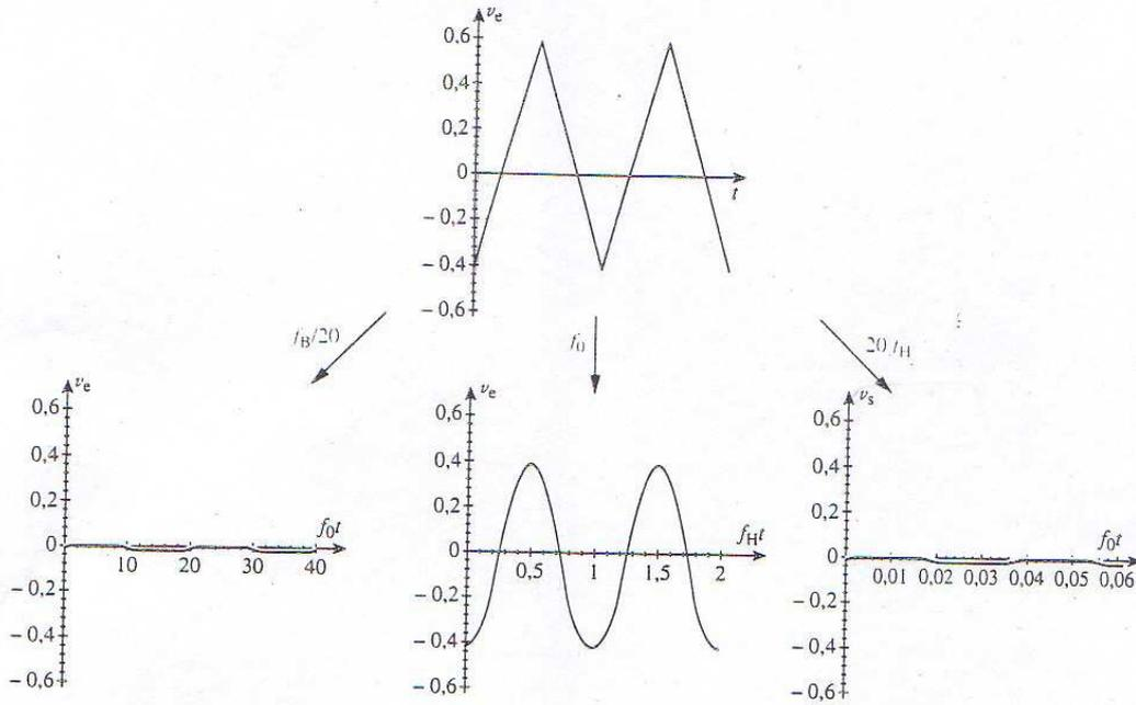
Filtre passe-bande de coefficient de qualité  $Q = 1$ ,  $f_B = 0,6 f_0$  et  $f_H = 1,6 f_0$ . Réponse à un signal triangulaire d'amplitude crête-crête de fréquence  $f_B/20, f_0, 20 f_H$  superposé à une composante continue de 0,1 V.
