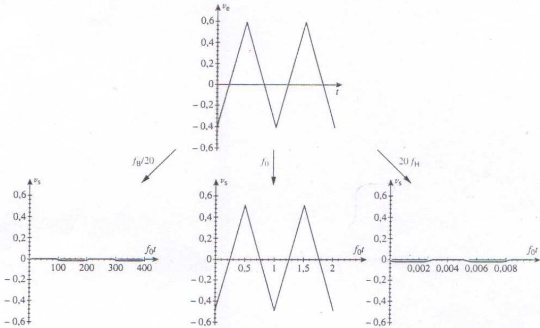
Filtre passe-bande de facteur de qualité  $Q = 0,1$ ,  $f_B = 0,1 f_0$  et  $f_H = 10 f_0$ . Réponse à un signal triangulaire d'amplitude crête-crête 1 V, de fréquence  $f_B/20$ ,  $f_0$  et  $20 f_H$ . Superposé à une composante continue de 0,1 V.
