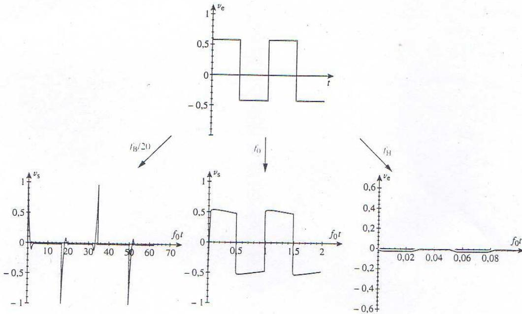
Filtre passe-bande de coefficient de qualité  $Q = 1$ ,  $f_B = 0,6 f_0$  et  $f_H = 1,6 f_0$ . Réponse à un signal en créneaux d'amplitude crête-crête 1 V de fréquence  $f_B/20, f_0, 20 f_H$  superposé à une composante continue de 0,1 V.
