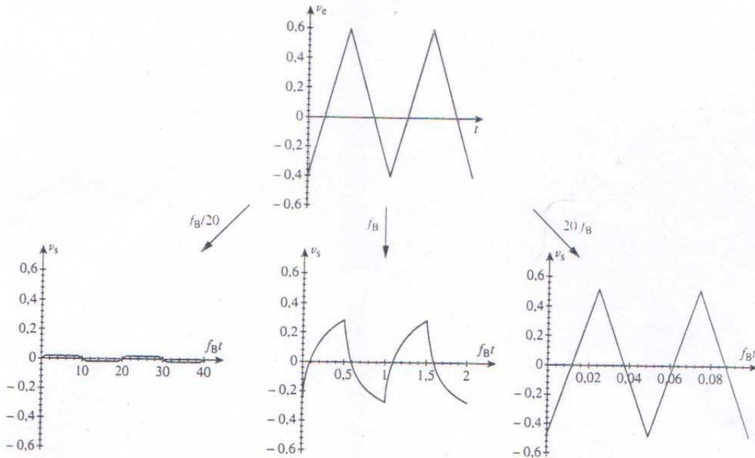
Filtre passe-haut du premier ordre. Réponse à un signal triangulaire d'amplitude crête-crête 1 V, de fréquence  $f_B/20$ ,  $f_B$  et  $20 f_B$ , superposé à une composante continue de 0,1 V.
