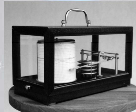
Manomètre anéroïde (à gauche) et manomètre enregistreur (à droite) : l'élément sensible est une capsule dont les déformations élastiques, en fonction des variations de pression, sont amplifiées. La capsule est reliée à un stylet encreur qui laisse une inscription sur une feuille millimétrée effectuant un tour hebdomadaire.
