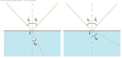
$n_2 > n_1$  le rayon se rapproche de la normale.  $n_2 < n_1$  le rayon s'éloigne de la normale. si  $i_1 > i_l$  tel que  $n_1 \sin i_l = n_2$  réflexion totale. Cf fibre optique, mirage.
