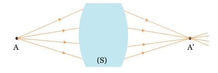
Toute l'énergie (électromagnétique) transportée dans le faisceau lumineux issu de A est concentrée en A' et peut y être mesurée par une cellule photoélectrique, peut impressionner un film photographique.
