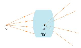
Un système optique (S') placé à droite de A' ou après  $(S_1)$  considérera A' ou A'' comme des **objets réels**.
