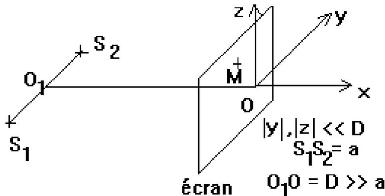
lieu des points d'éclairement maximal :  $M$  tel que :  $S_2M - S_1M = q \cdot \lambda_0$  ( $q$  entier) : hyperboloïdes de révolution de foyers  $S_1$  et  $S_2$
