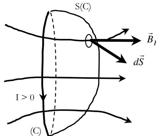
Le flux du champ magnétique propre à travers le contour orienté par le sens positif du courant choisi ou « flux propre » est proportionnel à  $I$  :
