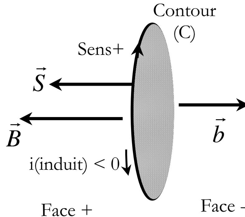
Le courant induit crée un champ magnétique propre  $\vec{b}$  ou « champ magnétique induit » responsable d'un flux magnétique à travers le circuit appelé « flux induit ».
