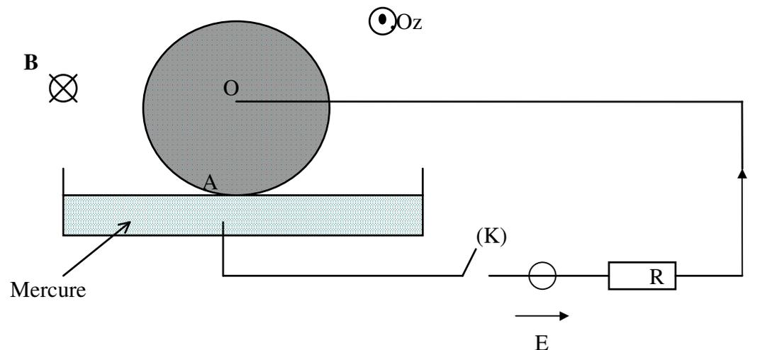
Le disque, parcouru par un courant imposé par le générateur, se met en mouvement (dû aux forces de Laplace dans un champ magnétique) ; ce mouvement va créer une fém d'induction (cas de Lorentz) dont les effets vont s'opposer à la cause de ce mouvement.
