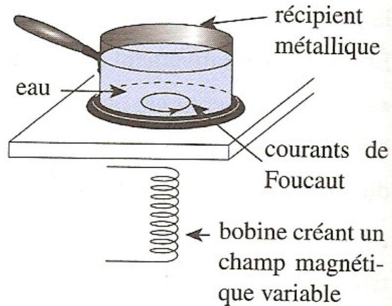
*Principe d'une plaque à induction : des courants apparaissent dans le récipient métallique soumis à un champ magnétique variable.*
