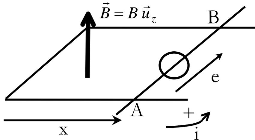
L'intensité qui traverse le circuit se calcule par la loi de Pouillet :
