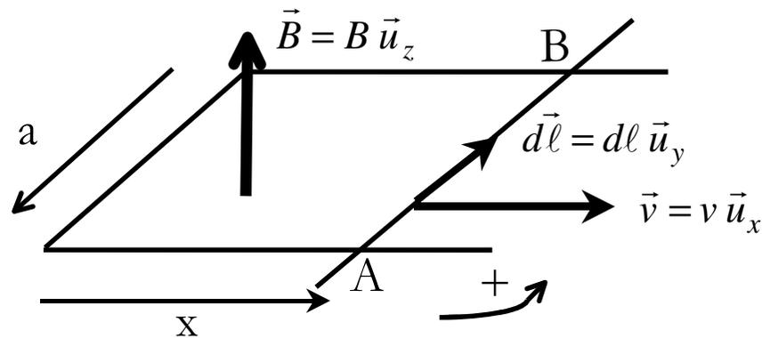
Ce circuit est placé dans un champ magnétique permanent  $\vec{B} = B \vec{u}_z$  d'origine extérieure à (C).
