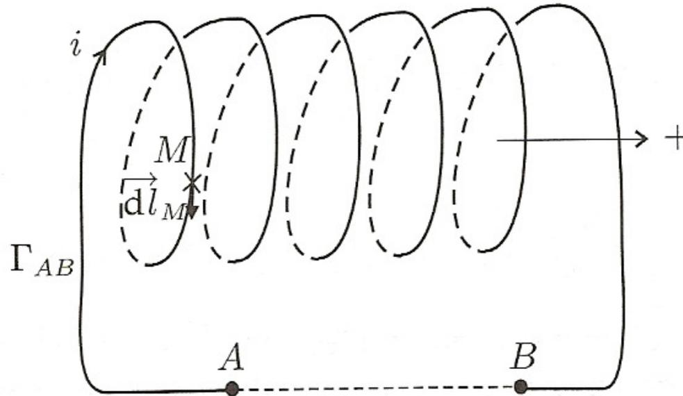
On calcule la circulation du champ électrique le long d'une portion de conducteur allant de A à B :
