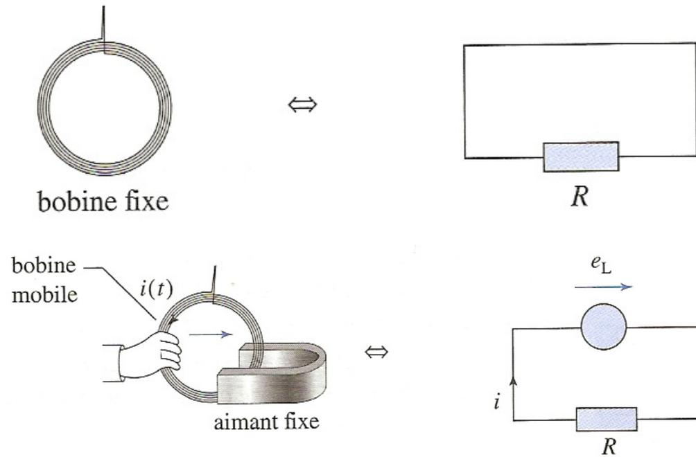
Ainsi, dans le référentiel du conducteur, apparaît un champ électromoteur  $\vec{E}_m$  à circulation non conservative, susceptible de mettre en mouvement relatif les porteurs de charges :
