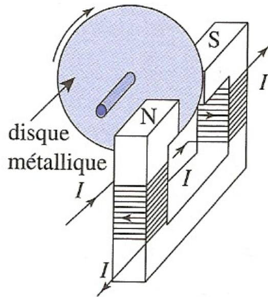
*Si aucun courant ne passe dans l'électro-aimant, le disque tourne librement ; dès que l'électro-aimant est excité, le disque est freiné.*
