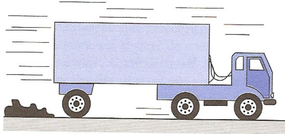
*Freinage par induction pour certains poids lourds : des courants de Foucault apparaissent dans une pièce (solidaire des roues) en mouvement dans un champ magnétique.*
