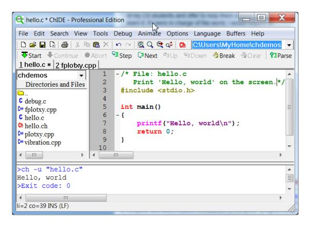
Ch est l'interpréteur C/C++ le plus complet. Il peut être embarqué dans vos applications. Il supporte la norme ISOI C (C90), la plupart des nouvelles fonctionnalités apportées par le C99, les classes en C++, OpenGL, ODBC, GTK+, C, LAPACK, CGI, XML, le
