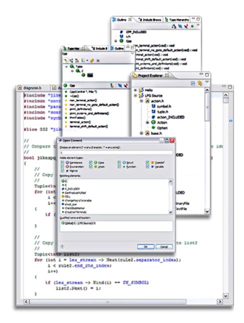
Eclipse CDT est l'un des IDE les plus puissants et les plus populaires. Il offre des fonctionnalités plus efficaces tels que le soutien à la création de projet et construction gérés pour différentes chaînes d'outils, make build standard, la navigation source, divers outils de connaissance de la source, l'éditeur de code avec la coloration syntaxique, le pliage et la navigation de liens hypertextes, le refactoring et la génération de code ainsi que des outils de débogage visuels.
